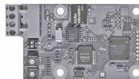
Fig. 62 Grundfos CIM communication interface module
